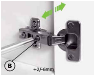
Независимая боковая регулировка Поворачивая винт «В», возможна регулировка расстояния наложения двери на боковую панель.
